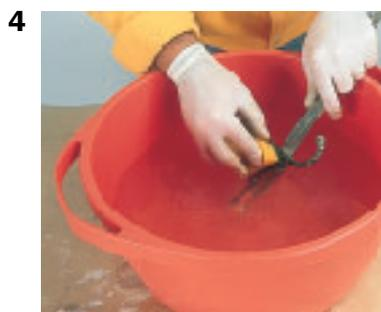
1. Enlever les traces de rouille du fourreau en les frottant avec de la laine d'acier moyenne.
